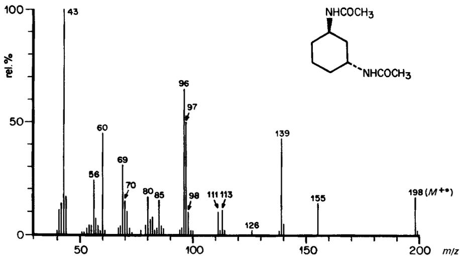
Fig. 2. Massenspektrum von trans-1,3-Diacetamidocyclohexan (trans-3) bei 70 eV<sup>3</sup>
